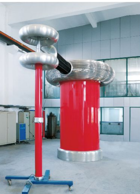
350kV 工频试验变压器 350kV Power Frequency Testing Transformer
